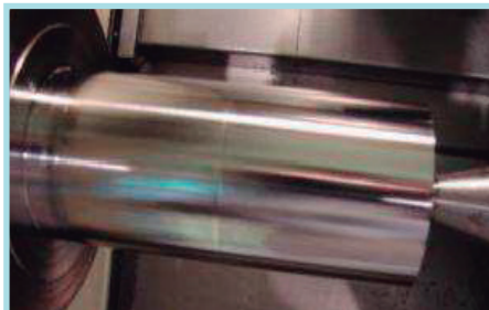
Probeta tras mecanizado con LN 2
